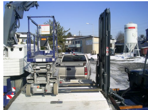
Abladen von einer Seite durch Teleskopgabel
